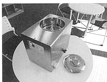
第1図 噴流式超音波洗浄機の試作機と原理図
