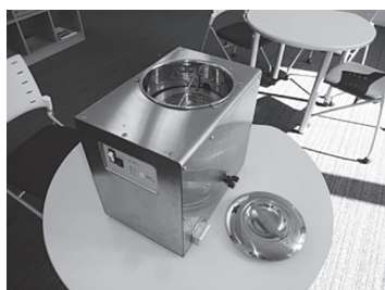
第1図 噴流式超音波洗浄機の試作機と原理図
